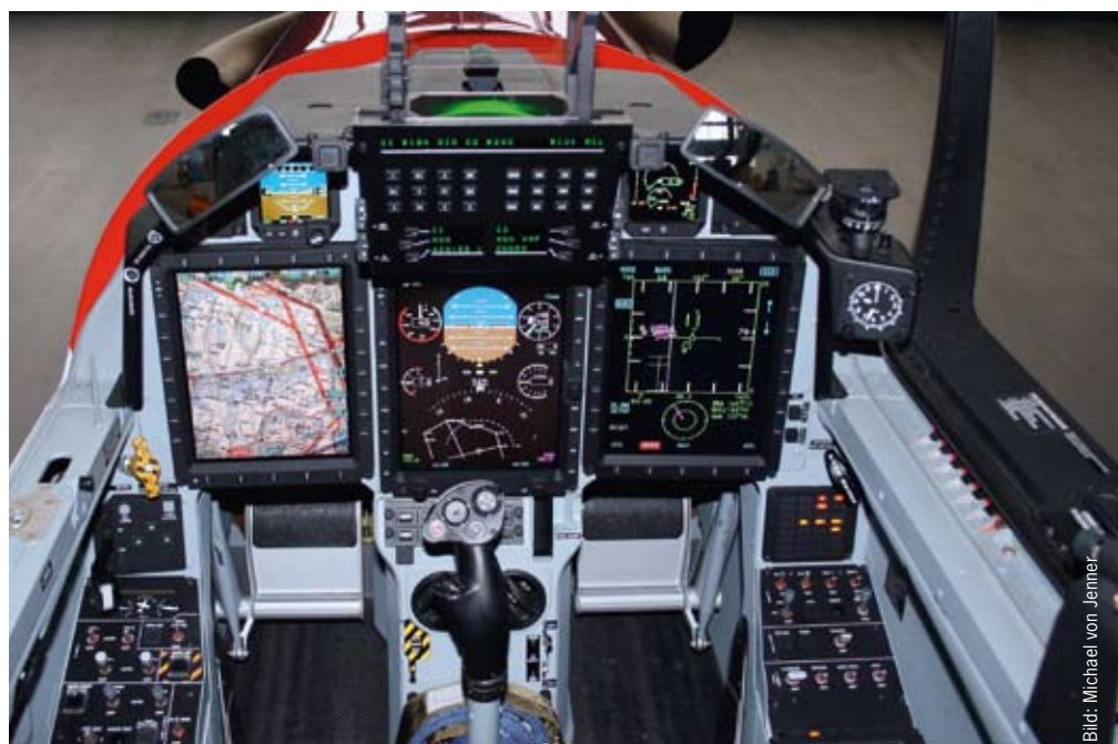
Das Cockpit des PC-21 ähnelt mit seinen drei grossen Bildschirmen jenem der F/A-18 Hornet.
