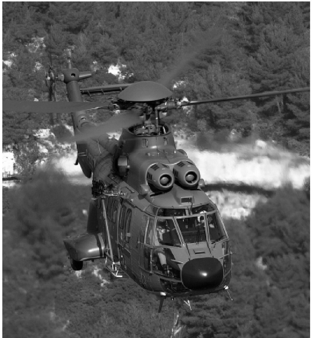
Von vorne erkennt man den Cougar am gegenüber dem Super Puma veränderten Lufteinlass der Triebwerke.
