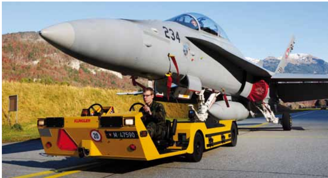
Mit 14 Kilowatt Leistung bewegt der LEKTRO-Schlepper Kampfflugzeuge wie die F/A-18.
