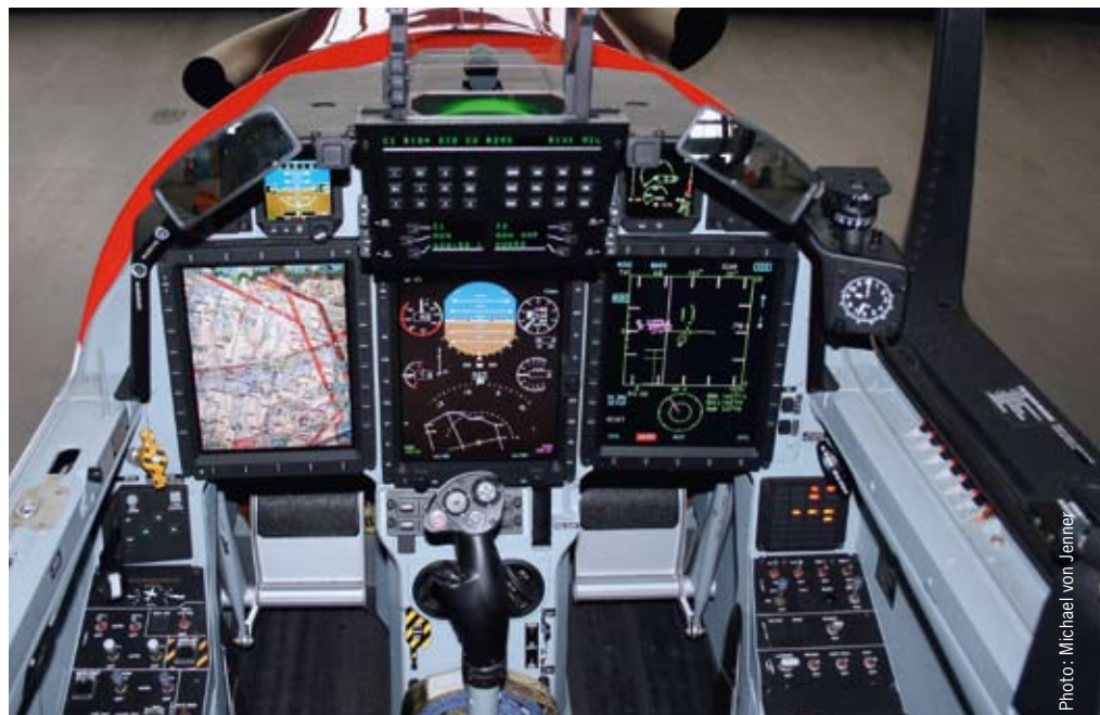
Avec ses trois grands écrans, le cockpit du PC-21 ressemble à celui du F/A-18 Hornet.
