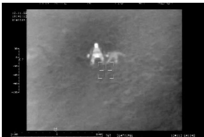
Les différences de température détectées par la caméra thermique sont si infimes que l'on distingue encore sur l'image l'empreinte laissée par une personne quelques instants auparavant.
