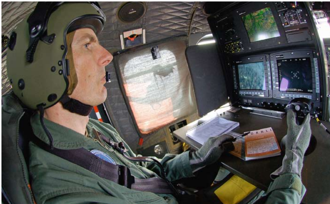
Le major Andri Spinas travaille avec une carte mobile (en-haut), une image vidéo (à gauche) et l'image thermique.
