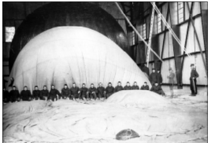
Umfüllen des Wasserstoffgases aus dem Drachenballon in den Kugelballon während der ersten RS.
